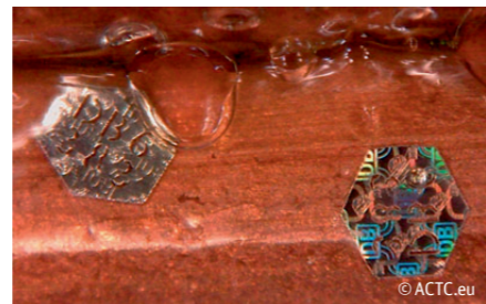
MarkXX sind die mikrolithografischen Plättchen (etwa 0,4 mm klein), die ACTC.eu für die Deutsche Bahn AG mit Hologramm oder Kodierung nutzt. Die Abbildung zeigt die MarkXX in der Markierungslösung „ACTC-DNA Industry 3“ unter normalem Licht auf dem Kupferkabel nach Anwendung mit FIMS (patentgeschützt).
