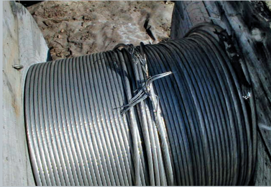
Fahrseil auf Kabeltrommel (Aluminium) 240 qmm, Durchmesser 20,3 mm
