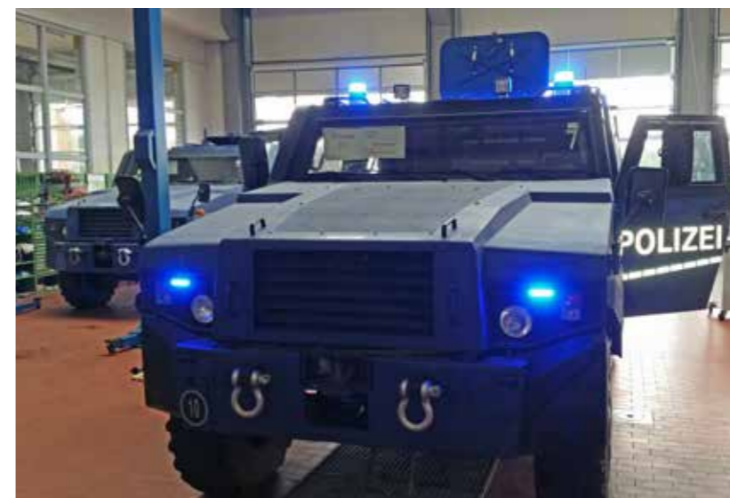
◀ Für ein Kfz bei der Polizei unabdingbar: Kennleuchten und Frontblitzer in blau
