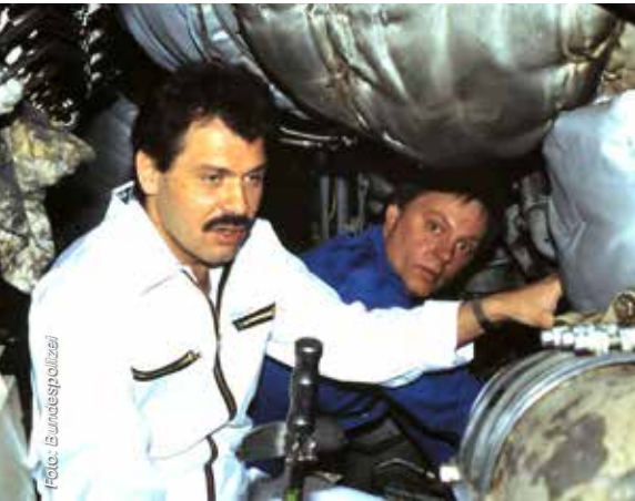
Die Steuerbordmaschine streikt. Reinhard Lademann und Klaus Freitag wechseln eine Zylinderkopfdichtung.
