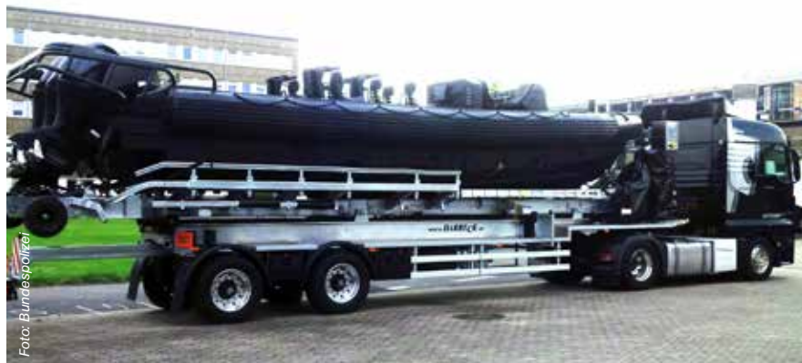
Der kran- und schlupffähige Traileraufbau wurde eigens für die GSG 9 angepasst.
