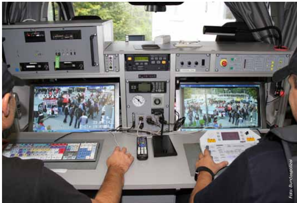
Der Bundespolizei steht eine moderne Auswertetechnik zur Verfügung: ein leistungsstarker mobiler Gerätesatz mit Videoschnitt- und Fotobearbeitungssoftware, Monitoren, Brenner, Scanner sowie ein Fotodrucker.
