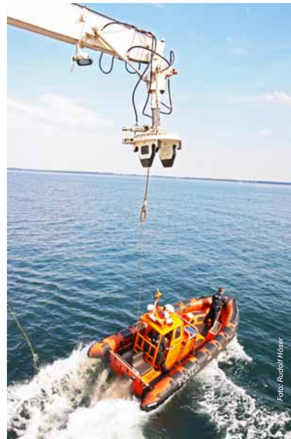
Der Kranausleger der BP 24 hat das Kontrollboot ausgesetzt. Mit voller Kraft geht die Fahrt zur nächsten Hafenkontrolle.
