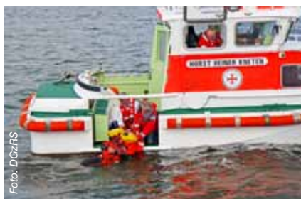
Die sogenannte Bergungspforte erleichtert die Rettung Schiffbrüchiger in Höhe der Wasserlinie.
