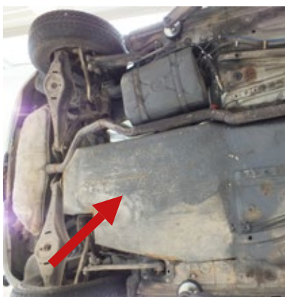
Nachträglich eingebaute Wanne zum verdeckten Transport von Personen
