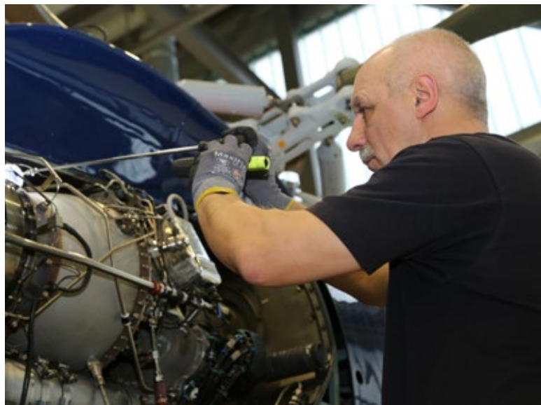
Sichtprüfung am Triebwerk der EC 155
